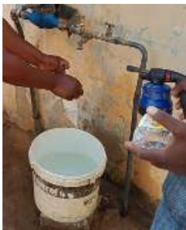
Photo I : Prélèvement d'échantillon au robinet d'un point sentinelle dans le département de l'Atlantique (Juin, 2022)
