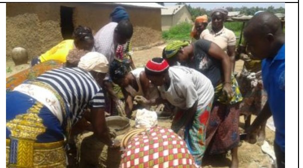
Photo 14 : lissage des foyers par les nouvelles monitrices
