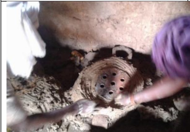
Photo 9 : réalisation de la base du foyer par les femmes
