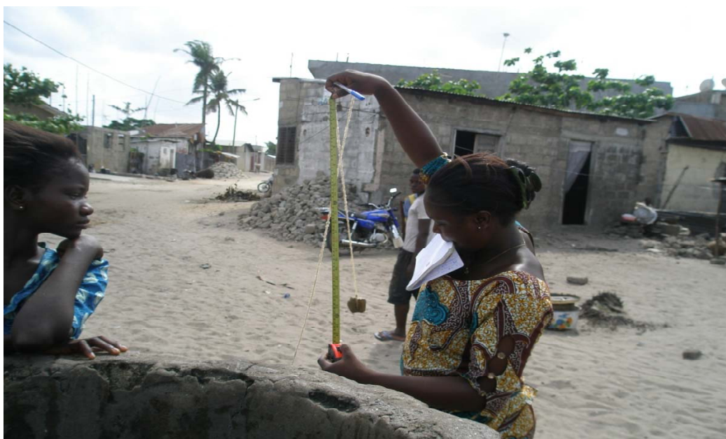
Agent d'Hygiène de la DHAB mesurant la profondeur de la colonne d'eau d'un puits afin de déterminer la quantité d'Hypochlorite nécessaire pour son traitement
